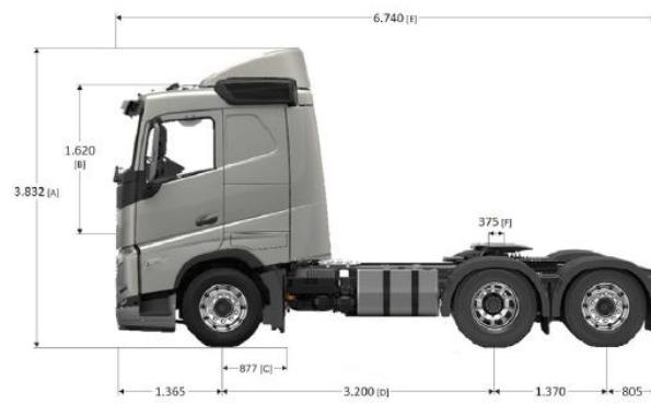
[A] Altura total. [B] Altura libre sobre túnel de motor. [C] Ancho desde centro de eje direccional a final de chapa de cabina. [D] Distancia entre ejes (opcional 3000/3500/3700 mm). [E] Largo total (variable según [D]). [F] Distancia entre centros del 1º tracción y de la 5º rueda. Todas las medidas son de referencia, para mayor detalle consultar con Ingeniería de Ventas.
