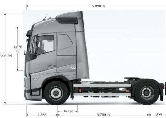
[A] Altura total [B] Altura libre sobre túnel de motor [C] Ancho desde centro de eje direccional a final de chapa de cabina [D] Distancia entre ejes (opcional 3500 mm) [E] Largo total (variable según [D])
