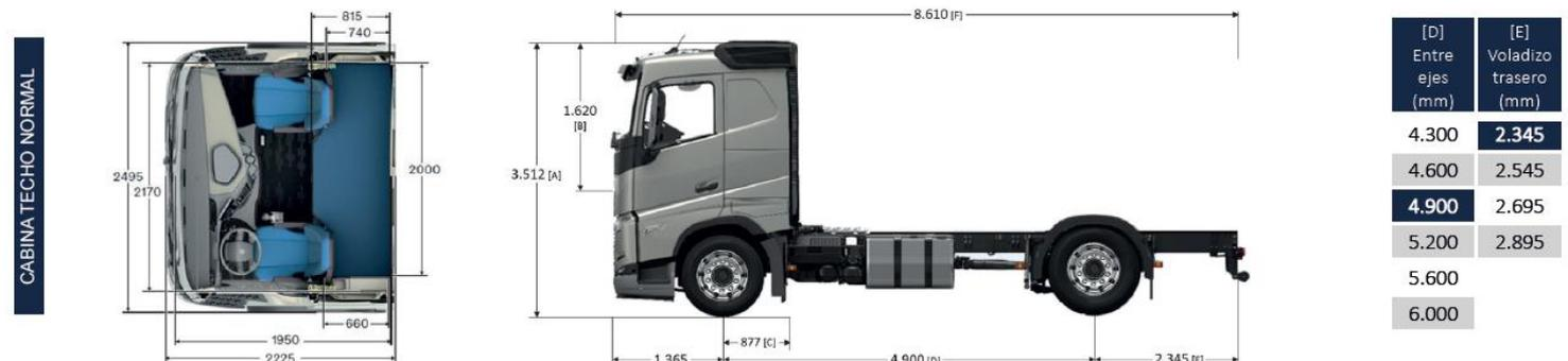
[A] Altura total. [B] Altura libre sobre túnel de motor. [C] Ancho desde centro de eje direccional a final de chapa de cabina. [D] Distancia entre ejes. [E] Largo voladizo trasero. [F] Largo total (variable según [D/E]). Todas las medidas son de referencia, para mayor detalle consultar con Ingeniería de Ventas.
