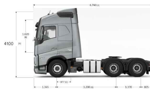
[A] Altura total. [B] Altura libre sobre túnel de motor. [C] Ancho desde centro de eje direccional a final de chapa de cabina. [D] Distancia entre ejes (opcional 3000/3500/3700 mm). [E] Largo total (variable según [D]). [F] Distancia entre centros del 1º tracción y de la 5º rueda. Todas las medidas son de referencia, para mayor detalle consultar con Ingeniería de Ventas.
