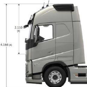
[A] Altura total. [B] Altura libre sobre túnel de motor. [C] Ancho desde centro de eje direccional a final de chapa de cabina. [D] Distancia entre ejes (opcional 3500 mm). [E] Largo total (variable según [D]). Todas las medidas son de referencia, para mayor detalle consultar con Ingeniería de Ventas.
