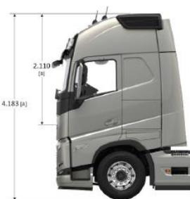
[A] Altura total. [B] Altura libre sobre túnel de motor. [C] Ancho desde centro de eje direccional a final de chapa de cabina. [D] Distancia entre ejes (opcional 3000/3500/3700 mm). [E] Largo total (variable según [D]). [F] Distancia entre centros del 1º tracción y de la 5º rueda. Todos los medidas son de referencia, para mayor detalle consultar con Ingeniería de Ventas.
