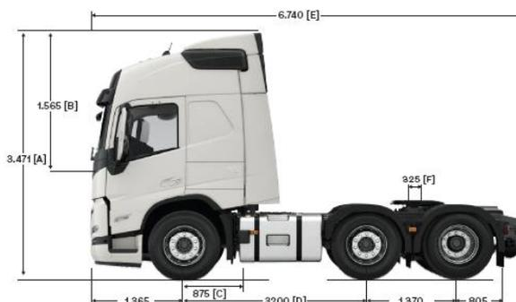
[A] Altura total. [B] Altura libre sobre túnel de motor. [C] Ancho desde centro de eje direccional a final de chapa de cabina. [D] Distancia entre ejes (opcional 3000/3500/3700 mm). [E] Largo total (variable según [D]). [F] Distancia entre centros del 1º tracción y de la 5ª rueda. Todas las medidas son de referencia, para mayor detalle consultar con Ingeniería de Ventas.
