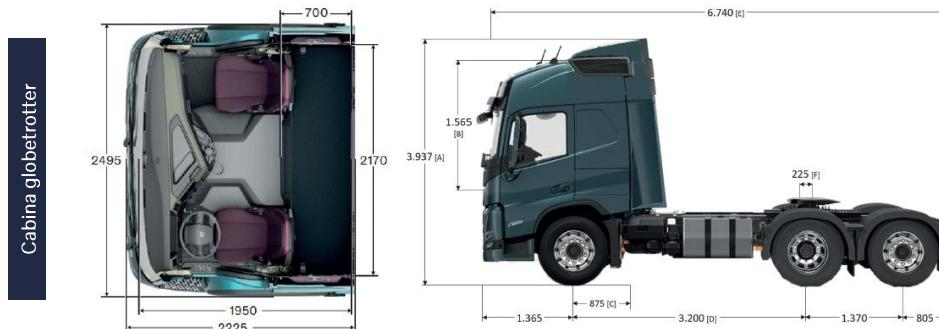
[A] Altura total. [B] Altura libre sobre túnel de motor. [C] Ancho desde centro de eje direccional a final de chapa de cabina. [D] Distancia entre ejes. [E] Largo voladizo trasero. [F] Largo total (variable según [D/E]). Todas las medidas son de referencia, para mayor detalle consultar con Ingeniería de Ventas.
