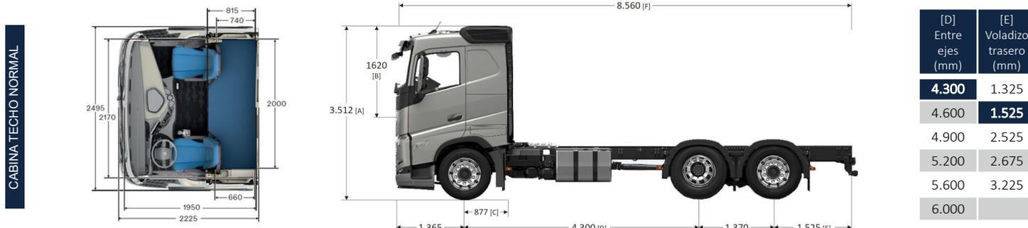
[A] Altura total [B] Altura libre sobre túnel de motor [C] Ancho desde centro de eje direccional a final de chapa de cabina [D] Distancia entre ejes [E] Largo voladizo trasero [F] Largo total (variable según [D/E]). Todas las medidas son de referencia, para mayor detalle consultar con Ingeniería de Ventas.
