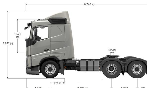
[A] Altura total [B] Altura libre sobre túnel de motor [C] Ancho desde centro de eje direccional a final de chapa de cabina [D] Distancia entre ejes (opcional 3000/3500/3700 mm) [E] Largo total (variable según [D]) [F] Distancia entre centros del 1º tracción y de la 5ª rueda. Todas las medidas son de referencia, para mayor detalle consultar con Ingeniería de Ventas.
