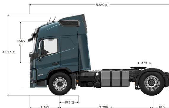
[A] Altura total. [B] Altura libre sobre túnel de motor. [C] Ancho desde centro de eje direccional a final de chapa de cabina. [D] Distancia entre ejes (opcional 3500 mm). [E] Largo total (variable según [D]). Todas las medidas son de referencia, para mayor detalle consultar con Ingeniería de Ventas.
