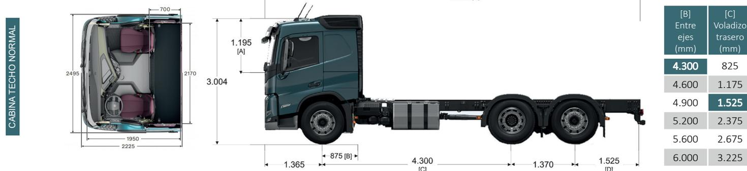
[A] Altura libre sobre túnel de motor. [B] Ancho desde centro de eje direccional a final de chapa de cabina. [C] Distancia entre ejes. [D] Largo voladizo trasero. [E] Largo total (variable según [C/D]). Todas las medidas son de referencia, para mayor detalle consultar con Ingeniería de Ventas.
