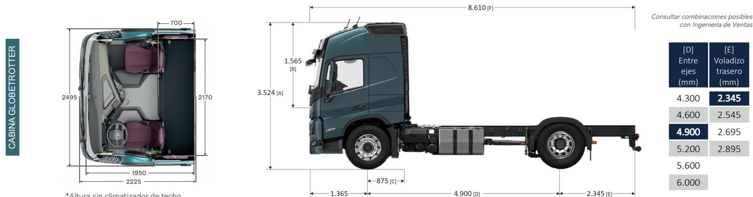
[A] Altura total. [B] Altura libre sobre túnel de motor. [C] Ancho desde centro de eje direccional a final de chapa de cabina. [D] Distancia entre ejes. [E] Largo voladizo trasero. [F] Largo total (variable según [D/E]). Todas las medidas son de referencia, para mayor detalle consultar con Ingeniería de Ventas.
