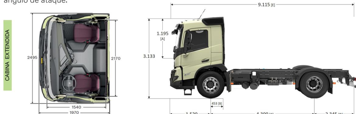
[A] Altura libre sobre túnel de motor. [B] Ancho desde centro de eje direccional a final de chapa de cabina. [C] Distancia entre ejes. [D] Largo voladizo trasero. [E] Largo total (variable según [C/D]). Todas las medidas son de referencia, para mayor detalle consultar con Ingeniería de Ventas.
