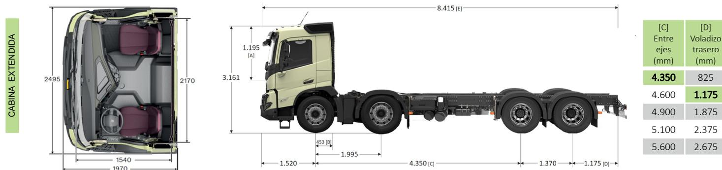
[A] Altura libre sobre túnel de motor. [B] Ancho desde centro de eje direccional a final de chapa de cabina. [C] Distancia entre ejes. [D] Largo voladizo trasero. [E] Largo total (variable según [C/D]).
