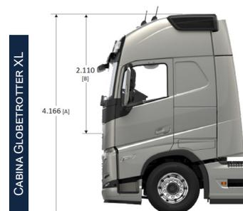
[A] Altura total. [B] Altura libre sobre túnel de motor. [C] Ancho desde centro de eje direccional a final de chapa de cabina. [D] Distancia entre ejes (opcional 3500 mm). [E] Largo total (variable según [D]). Todas las medidas son de referencia, para mayor detalle consultar con Ingeniería de Ventas.
