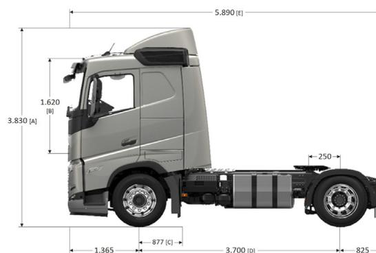
[A] Altura total [B] Altura libre sobre túnel de motor [C] Ancho desde centro de eje direccional a final de chapa de cabina [D] Distancia entre ejes (opcional 3500 mm) [E] Largo total (variable según [D])
