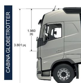
[A] Altura total [B] Altura libre sobre túnel de motor [B] Ancho desde centro de eje direccional a final de chapa de cabina [C] Distancia entre ejes [D] Largo total (variable según [C])
